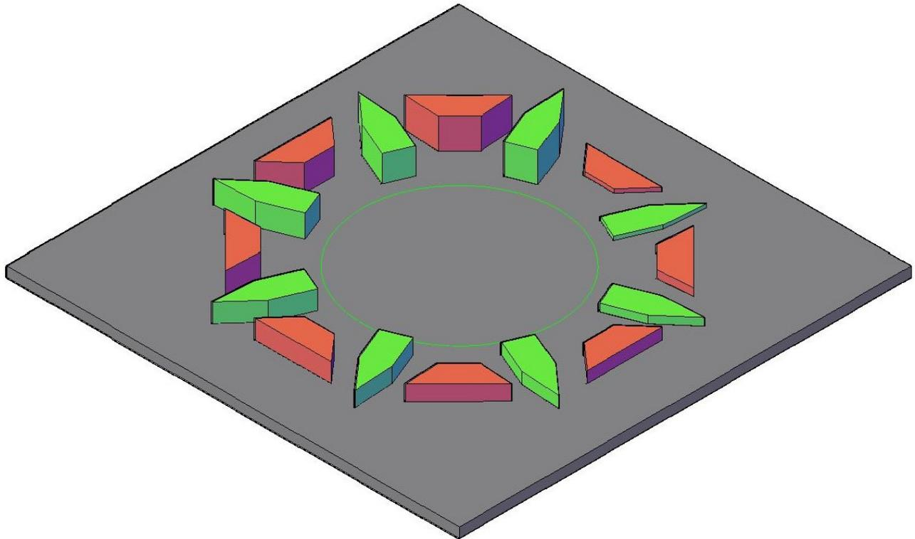
**CARACTERÍSTICAS:** (A) EL INICIO (PIEZA ROJA) Y EL FINAL (PIEZA VERDE) INICIAN CON 4 CMS. DE ALTURA Y VAN DISMINUYENDO DE PAR EN PAR HASTA LLEGAR A 0.5 CMS. DE ALTURA, ESTO SUCEDE EN SENTIDO CONTRARIO A LAS MANECILLAS DEL RELOJ.
