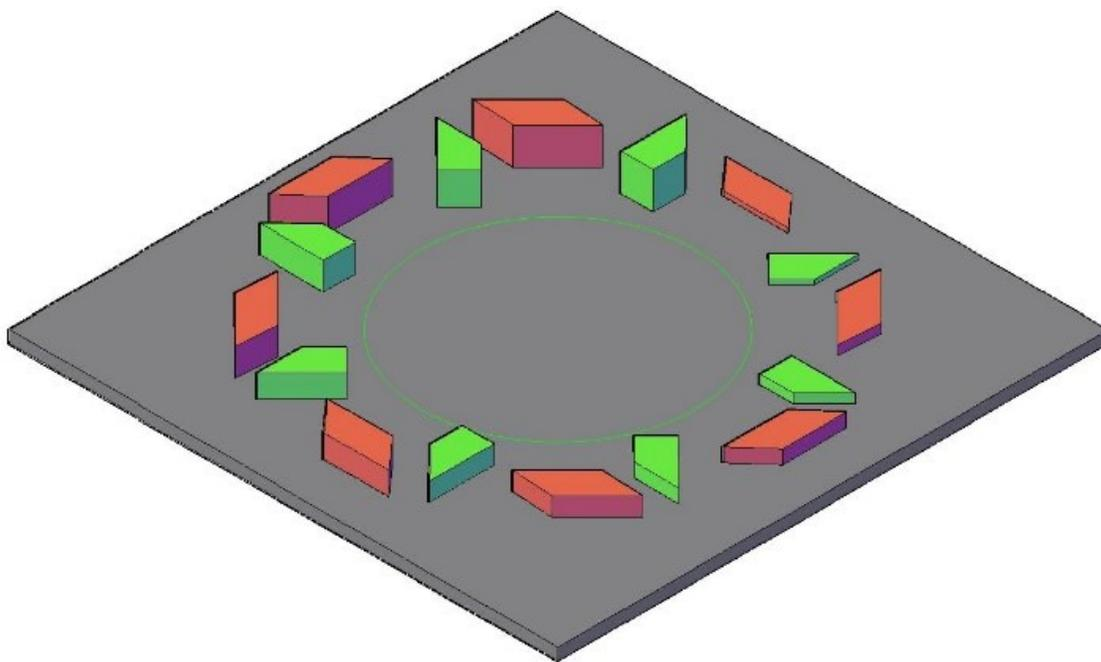
**CARACTERÍSTICAS:** (A) EL INICIO (PIEZA ROJA) Y EL FINAL (PIEZA VERDE) INICIAN CON 4 CMS. DE ALTURA Y VAN DISMINUYENDO DE PAR EN PAR HASTA LLEGAR A 0.5 CMS. DE ALTURA, ESTO SUCEDE EN SENTIDO CONTRARIO A LAS MANECILLAS DEL RELOJ.
